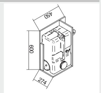
Kompakte Abmessung. Bequemer Transport des Tanks durch Griff und stabile Rollen.
