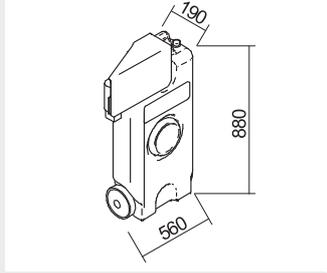
Kompakte Abmessung, fahrbarer Tank, bequemer Transport durch Griff und Rollen.
